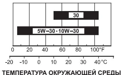
Масло SAE 10W-30 рекомендуется для использования в большинстве окружающих условий. Прочие вязкости, приведенные в таблице, могут использоваться при указанных температурах окружающего воздуха на месте эксплуатации агрегата.
